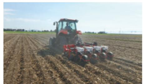
写真3 大豆用高速畝立て播種機(試作4条機)
