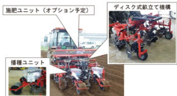
写真2 大豆用高速畝立て播種機(試作2条機)
